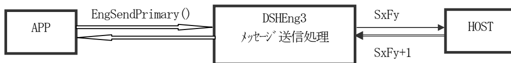
図 4.3.1.2-5 DSHEng3 のAPPからの1次メッセージ送信要求処理の関連図
